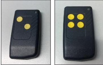
Die Zugehörigkeit von Fernbedienung und Schranke kann erlernt werden. Sie wird auf der Steuerplatine gespeichert und kann bei Bedarf auch wieder gelöscht werden.
