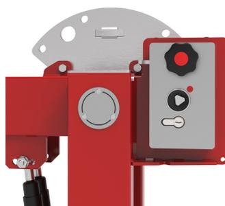
Optional: System Schlosskasten mit Profilhalbzylinder 30/10 und Feuerwehr-Dreikant ähnlich DIN 3223 mit Edelstahl-Riegelbolzen und automatischer Verriegelung in den Endlagen.
